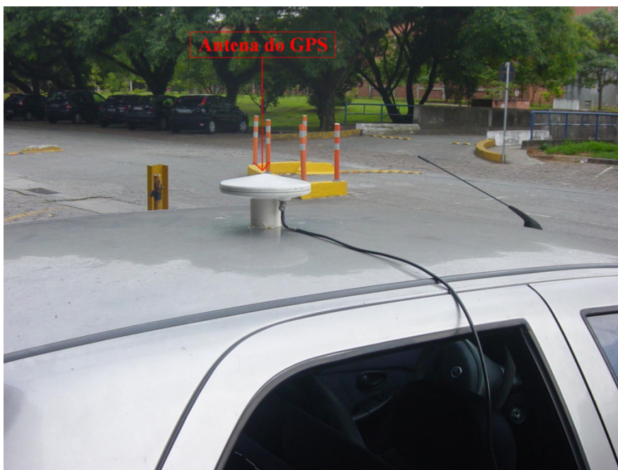
Figura 5.42 – Fixação da Antena do GPS no Carro
